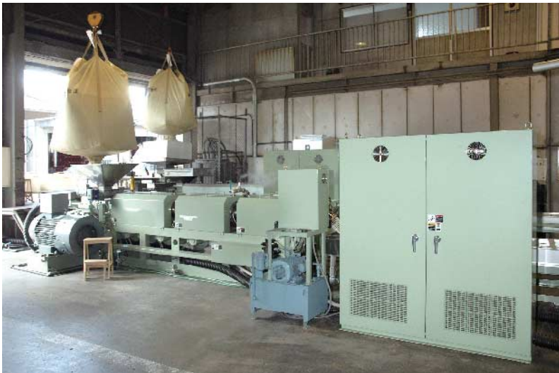
ペレットの押出工程ライン
