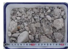
RC-40再生砕石 ・道路舗装の下層路盤材
