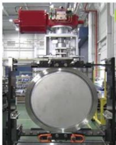
高さ2.3m、重さ1.2tの船舶排ガス用バルブ
