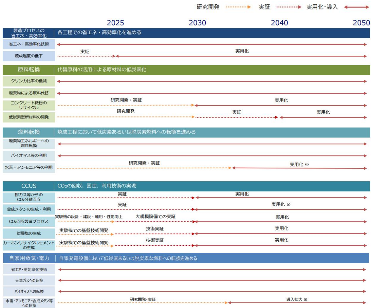
図 37：セメント分野のカーボンニュートラルへの技術の道筋（抜粋） 78
